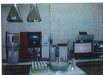
Spectrofotometru de absorbție atomică - cu flacără, cuptor de grafit, sistem de hidruri cu amalgamare și sistem de solide automat CONTRAA
