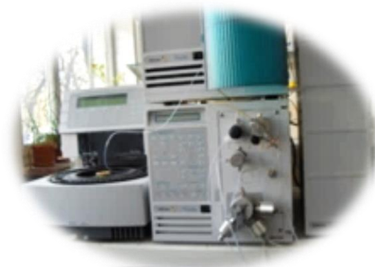
Sistem modular UHPLC ONLINE SPE – EQuan MAX cuplat cu spectrometru de masă cu triplu cuadropol LC-MS/MS TSQ Quantiva
