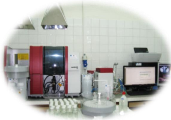
Spectrofotometru de absorbție atomică - cu flacăără, cuptor de grafit, sistem de hidruri cu amalgamare și sistem de solide automat CONTRAA
