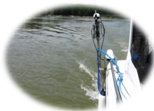
Sistem multibatimetric Kongsberg GeoSwat Plus Compact montat pe ambarcațiunea Ranieri CLF22
