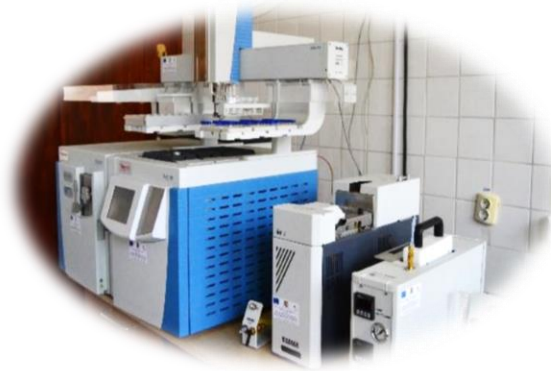
Sistem GC-MS/MS Trace 1310 cuplat cu spectrometru de masa TSQ 8000 Evo, Thermo Scientific
