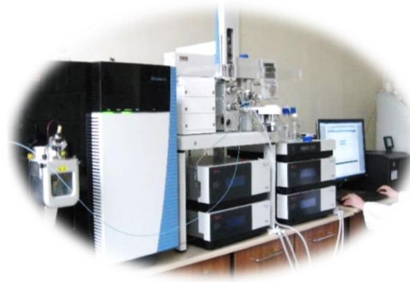
Sistem modular UHPLC ONLINE SPE – EQuan MAX cuplat cu spectrometru de masă cu triplu cuadropol LC-MS/MS TSQ Quantiva
